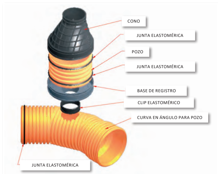
INSTALACIÓN DE POZOS EN COLECTORES CON CAMBIO DE DIRECCIÓN.
