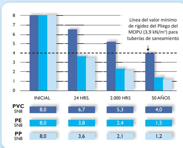
EVOLUCIÓN DE LA RIGIDEZ RCE = (E<sub>c</sub>I)/D<sub>m</sub><sup>3</sup> CON EL TIEMPO SEGÚN LA NORMA DIN 16961
