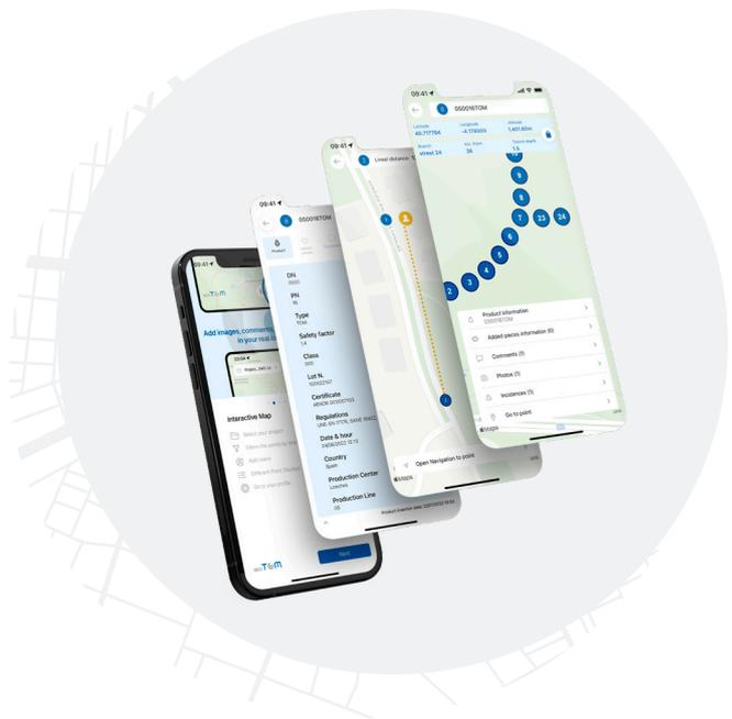
La aplicación desarrollada por **Molecor** permite la creación de trazados virtuales completos con todos los datos de cada pieza de una red de canalización. El uso de la app **geoTOM®** facilita el acceso a información técnica precisa de las redes hídricas para garantizar una mayor capacidad de control y gestión del agua.
