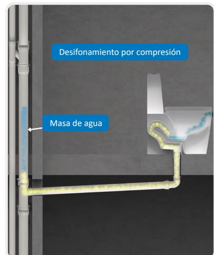
Figura 2. Esquema de un sistema de desagüe que puede producir sifonamiento por compresión. >>>
